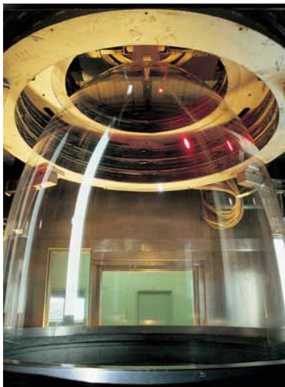
Exclusivo processo bolha de propriedade da Innovia Films produz polímero de alta performance para cédulas bancárias
